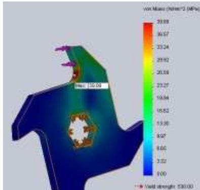
**Gambar 7.** Tegangan Pada mata potong 7 mm
