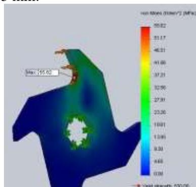
**Gambar 6.** Tegangan Pada mata potong 5 mm
