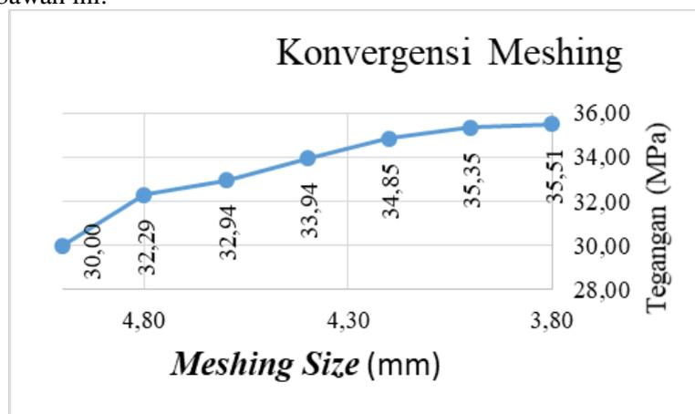
**Gambar 5.** Diagram Hasil Konvergensi Mesin
