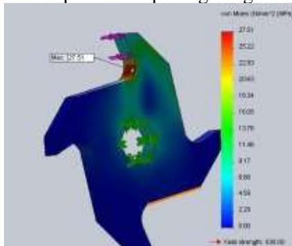
**Gambar 8.** Tegangan pada Mata Potong 10 mm
