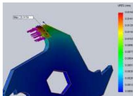
Gambar 14. *Displacement* pada ASTM A36 dan AISI 1045
