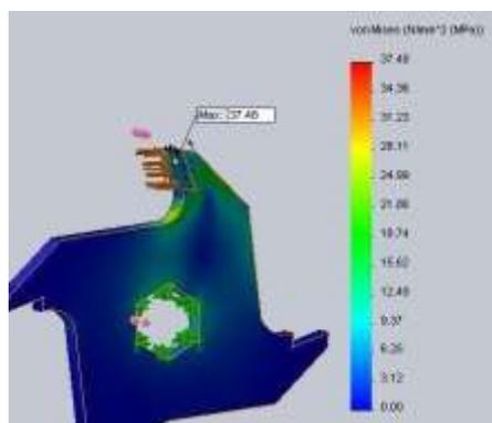
**Gambar 12.** Tegangan Pada ASTM A36 dan *JIS SKD 11*
