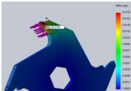
Gambar 16. *Displacement* Pada ASTM A36 dan *JIS SKD 11*
