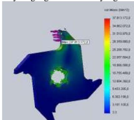
**Gambar 10.** Tegangan Pada ASTM A36 dan AISI 1045
