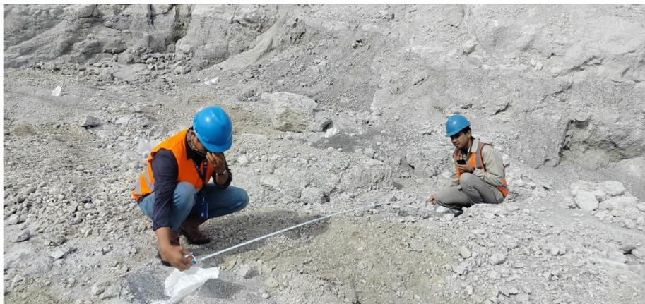
**Gambar 4. Pengukuran Diameter Lubang Burden dan Spacing**
