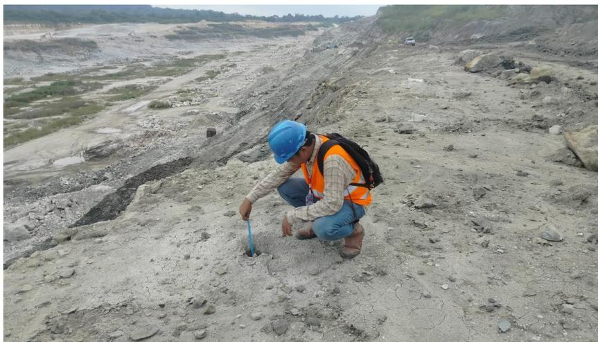
**Gambar 5 Pengukuran Kedalaman Lubang**
