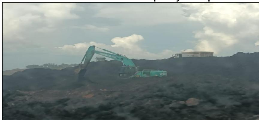
**Gambar 4. Penanganan Swabakar Dengan Menggunakan Excavator Kobelco SK200-12 Pada Temporary Stockpile BWE**
