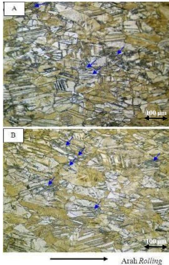
**Gambar 9.** Struktur mikro paduan Cu-Zn 70/30 hasil *warm rolling* pada suhu 300 °C dengan 50 % reduksi dengan mikroskop optik; (a) Bagian tepi, (b) Bagian tengah. Garis-garis berwarna hitam menggambarkan pita deformasi yang semakin banyak (ditunjukkan dengan panah). Etsa FeCl<sub>3</sub> 10%
