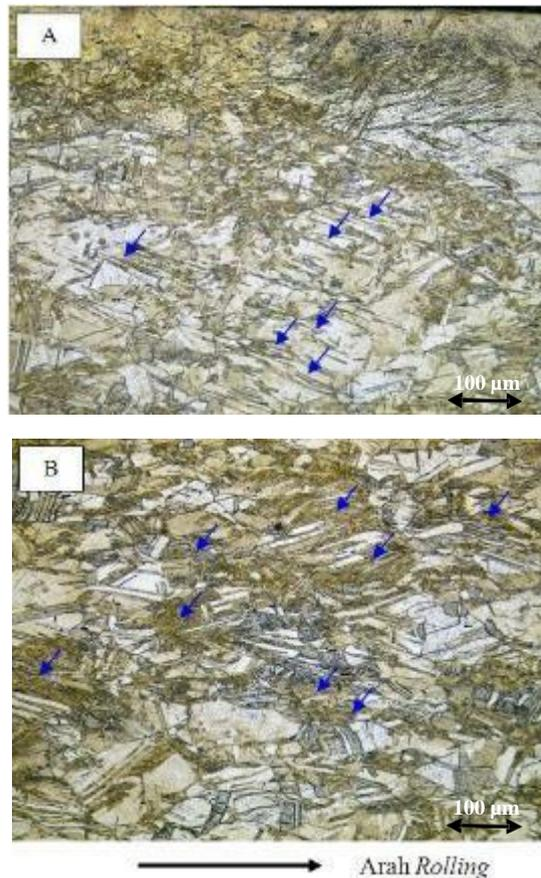
**Gambar 11.** Pengamatan struktur mikro untuk paduan Cu- Zn 70/30 hasil *warm rolling* pada suhu 300 °C, 60% reduksi (A) Bagian tepi, (B) Bagian tengah Etsa : FeCl<sub>3</sub> 10%. Garis-garis sejajar dan berwarna hitam menggambarkan *deformation band* yang semakin banyak
