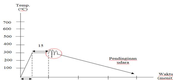
**Gambar 4.** Diagram tahapan *warm rolling* pada suhu 300 °C dengan metode *double pass reversible*
