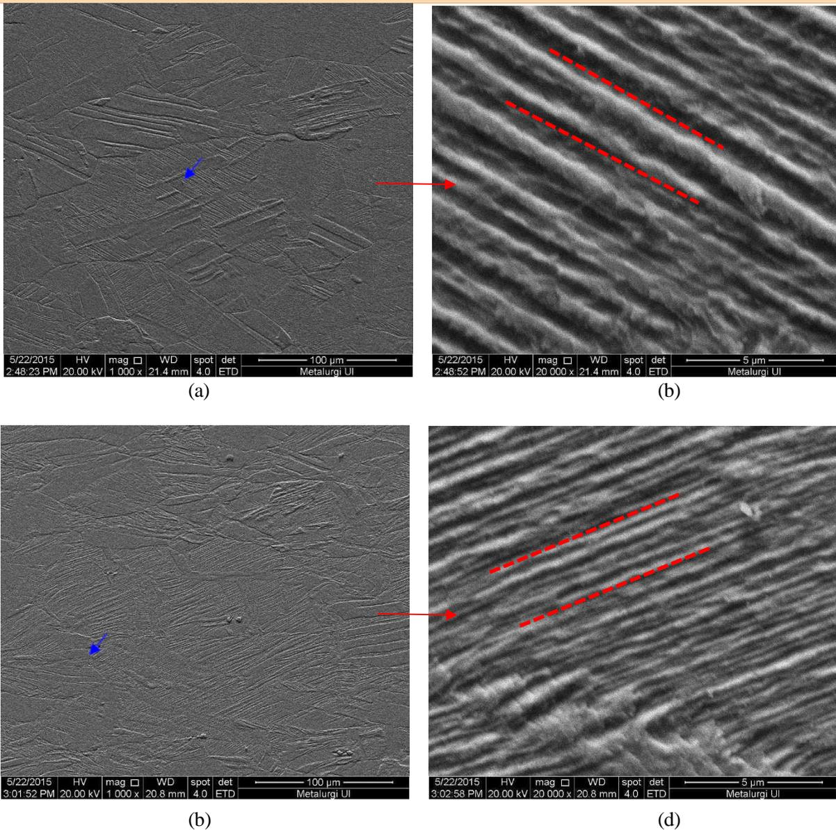
**Gambar 13.** Pengamatan *deformation band* dalam paduan Cu-Zn 70/30 hasil *warm rolling* pada suhu 300 °C, pada bagian tengah dengan % reduksi dan perbesaran; (a)50%-1000X; (b)50%-20000X, perbesaran dari area (a) yang ditandai panah biru; (c) 60% - 1000X; (d) 60%-20000X, perbesaran dari area (c) yang ditandai panah biru. Etsa : FeCl<sub>3</sub>
