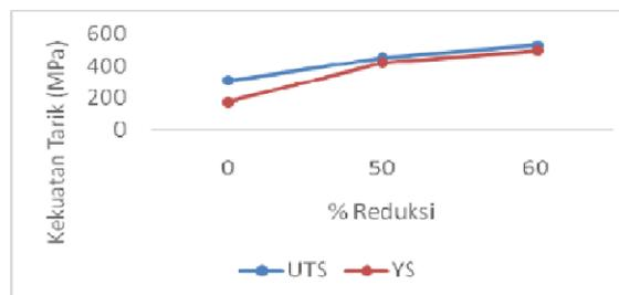
**Gambar 7.** Hubungan antara % reduksi dengan UTS maupun YS (MPa) pada paduan Cu-Zn 70/30 yang dilakukan *warm rolling* pada suhu 300 °C
