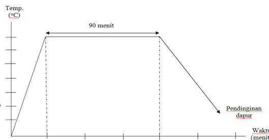
**Gambar 3.** Diagram tahapan homogenisasi pada suhu 700 °C selama 90 menit<sup>[7]</sup>
