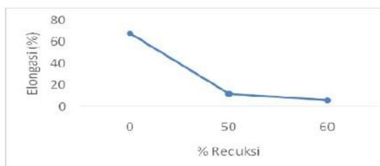
**Gambar 8.** Hubungan antara % reduksi dengan elongasi (%) pada paduan Cu-Zn 70/30 yang dilakukan *warm rolling* pada suhu 300 °C
