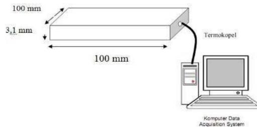
**Gambar 2.** Ilustrasi rangkaian pengujian *warm rolling*<sup>[6]</sup>
