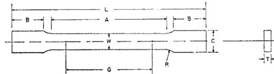
**Gambar 5.** Sampel uji tarik dari paduan Cu-Zn 70/30 dimana  $L = \text{minimal } 100 \text{ mm}$ ,  $G = 25 \text{ mm}$ , dan  $C = 10 \text{ mm}$
