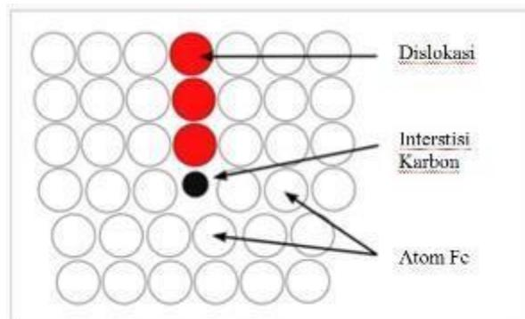
**Gambar 1.** Ilustrasi atmosfer cottrell, dimana atom karbon tersegregasi dalam dislokasi<sup>[11]</sup>
